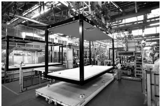
構造だけで阪神淡路大震災の1.5倍の地震でも倒れない強度を実現
